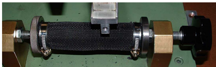
Fig. 1 - Prova di abrasione secondo UNI ISO 6945. Abrasion test in accordance with UNI ISO 6945.
