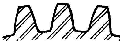
Paso Diametral 5 Paso Circular de 0.6283"
