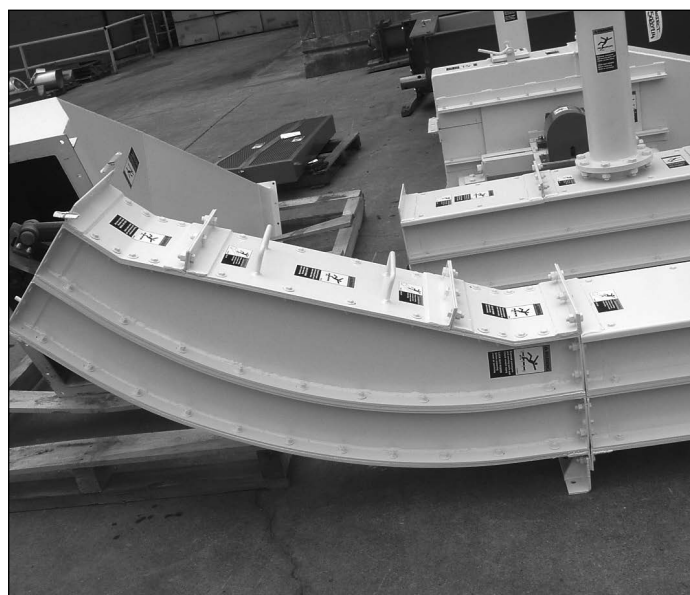
Rastra MLP con inferior espacio en el codo inferior para acomodar el lado flojo de la cadena
