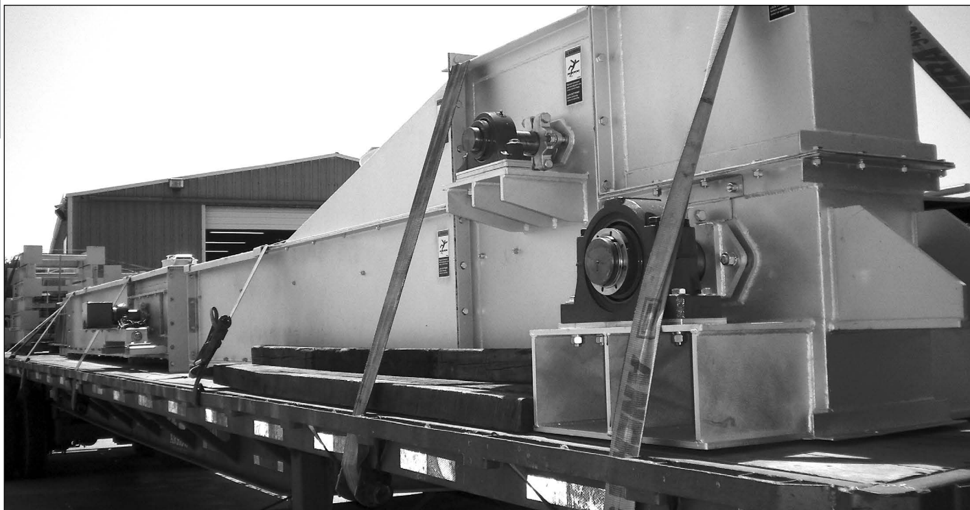
Cabeza con Sprocket de Tensión del Lado Flojo de una Rastra Super Capacidad MSC
